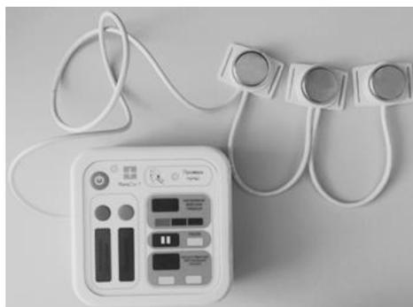
Рис. 1- внешний вид программно-аппаратного комплекса для контроля проведения процедуры СЛР
