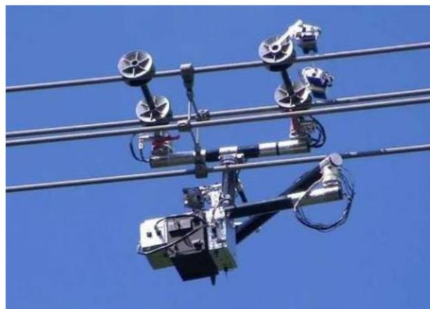
Рис. 4. Колёсный робот Expliner
