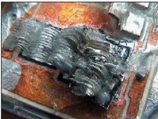
Рис. 2. Повреждение кристаллов IGBT в результате перегрева [4]
