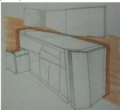
Рис. 1. Эскиз модульного функционального рабочего места автослесаря
