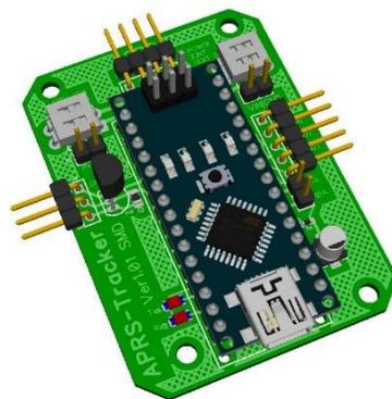
Рис. 1. - 3D модель APRS трекера
