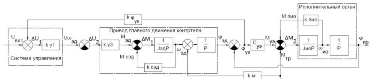
Рис. 3. Структурная схема узла динамического нагружения.
