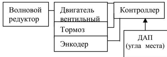
Рис. Структурная схема мехатронного модуля солнечной панели.
