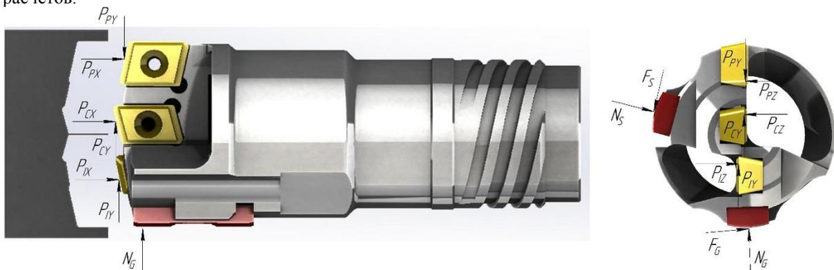
Рис. 1. Система сил, действующих на сверло БТА
