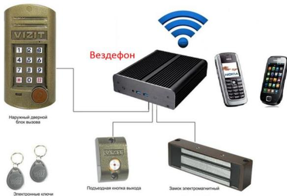
Рис. 2. Схема подключения «Взамен»
