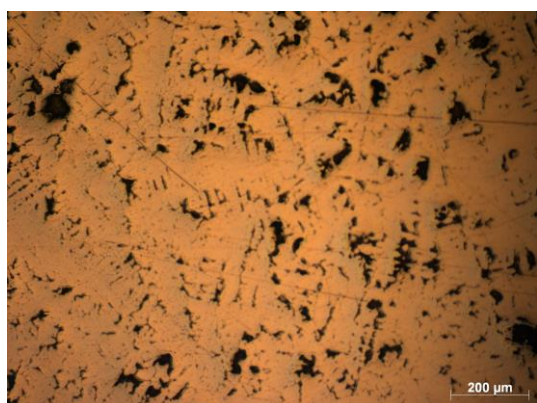
Рис.1 Микроструктура двухкомпонентных свинцовистых бронз марки БрС 30 полученных: а – с низкой; б - с высокой скоростью охлаждения.
