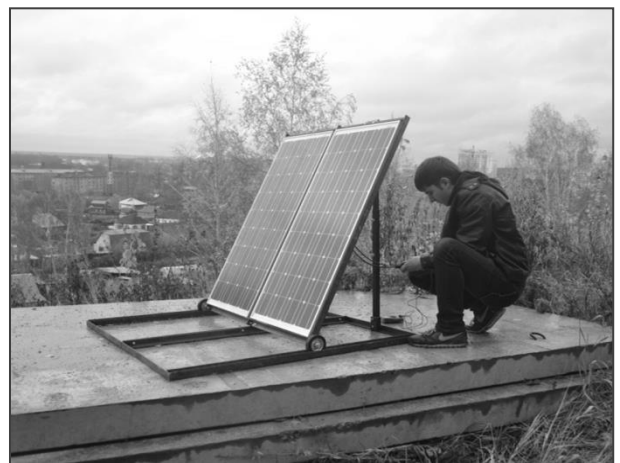
Рис.2 Измерение мощности панели на разработанной конструкции
