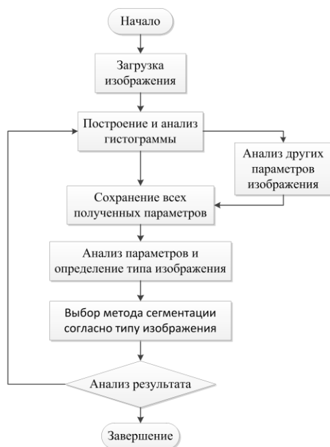
Рис. 2. Схема автоматического подбора алгоритма сегментации изображения
