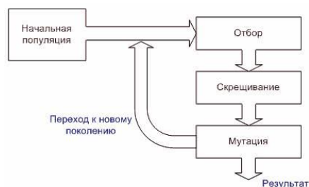
Рис. 2. Схема работы генетического алгоритма Алгоритм решения задачи
