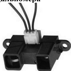
Рис. 1. ИК дальномер SHARP GP2Y0A02
