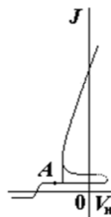
Рис. 1. Схематическое изображение ВАХ ТЭП и распределения параметров плазмы (точка А – диффузионный режим)
