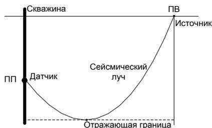
Рис. 1. Схема прохождения отдельного луча при ВСП в градиентной среде
