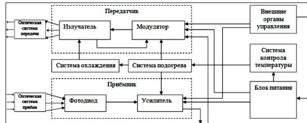
Рис.1. Структурная схема приёмно-передающего модуля АОЛС
