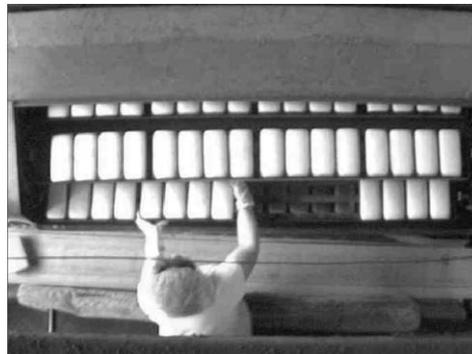
Рис.1. Пример попадания в область контроля посторонних динамических объектов
