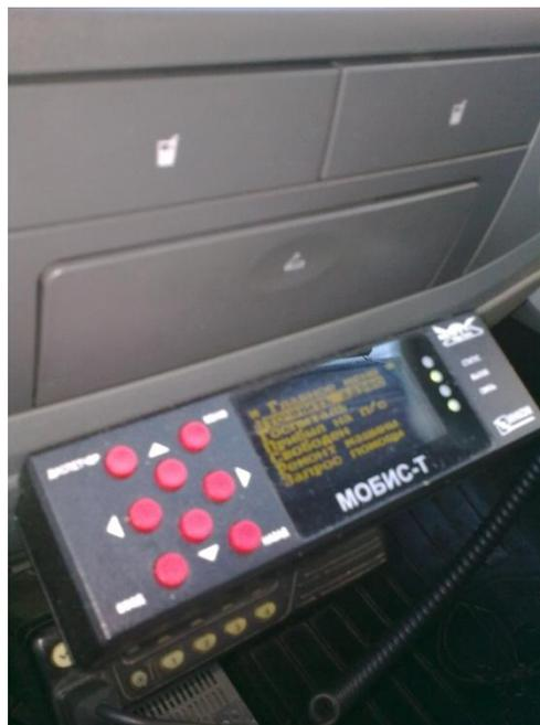
Рис. 1. Дисплей мобильного терминала «Мобис» на передней панели автомобиля
