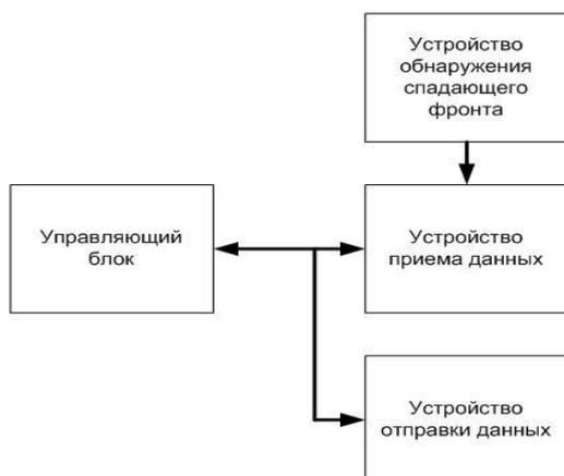
Рис.2. Структурная схема устройства работы с последовательным портом
