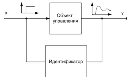
Рис. 3. Общая схема прибора идентификатора
