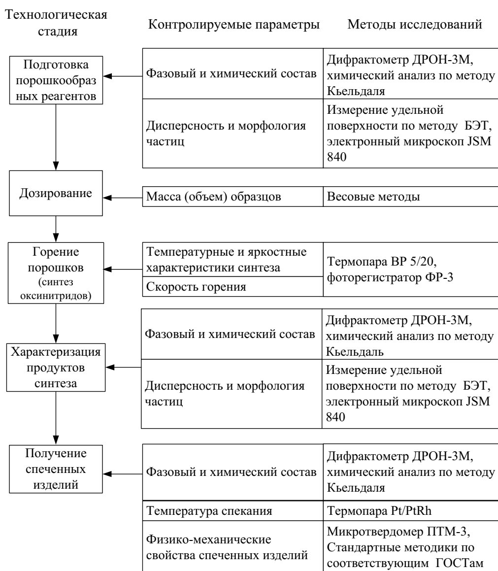
Рис. 6.3. Технологическая схема получения оксидно-нитридной керамики
