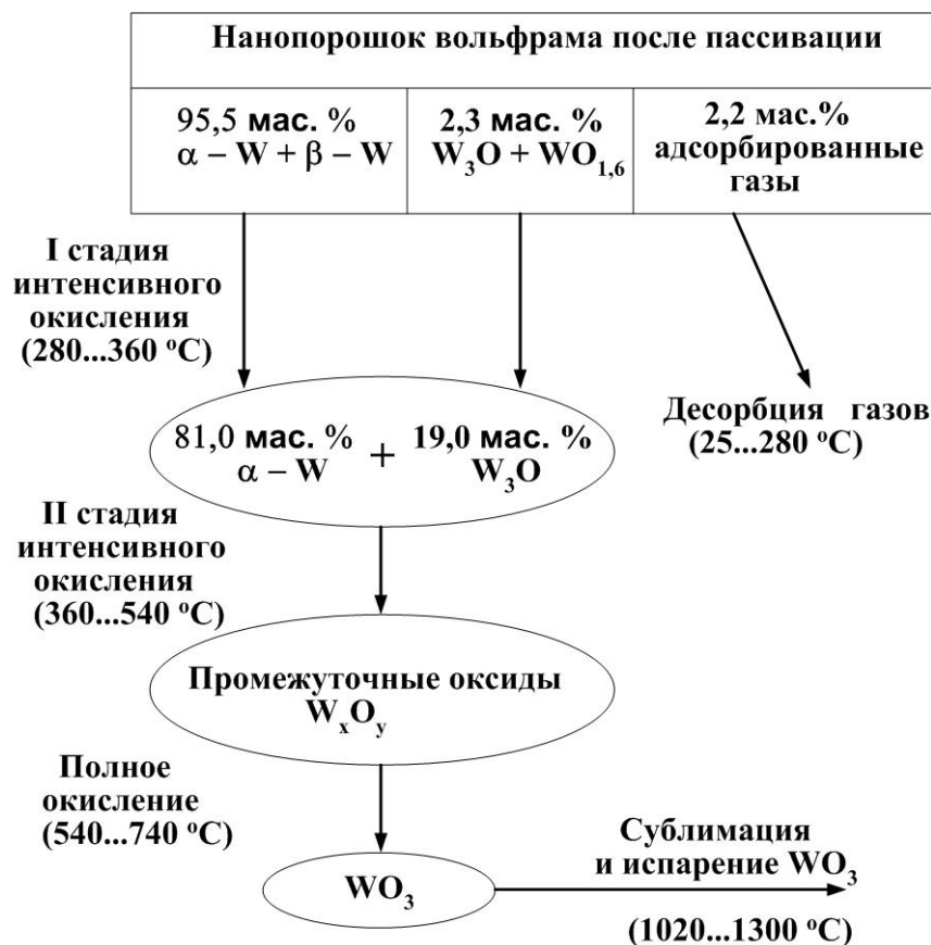
Рис. 2.22. Схема химических процессов окисления НП W в воздухе
