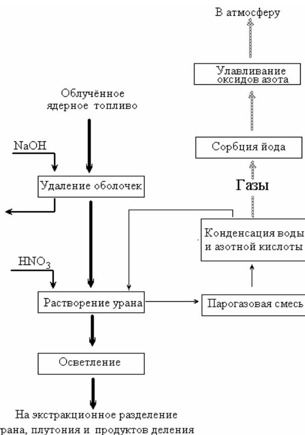
Рис. 52. Технологическая схема растворения ОЯТ
