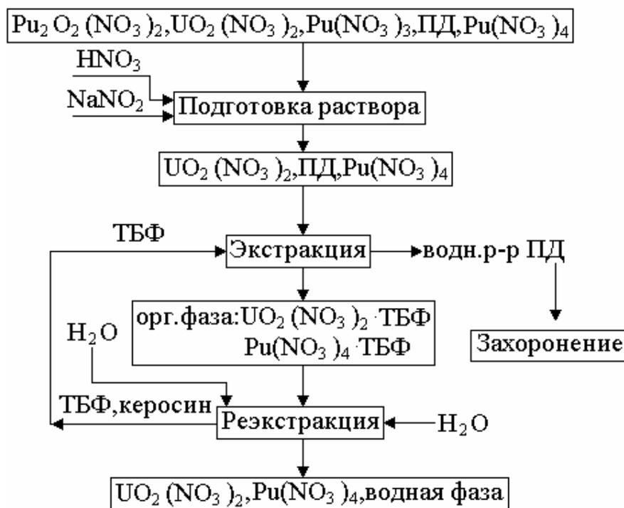
*Рис. 54. Цикл очистки от продуктов деления*
