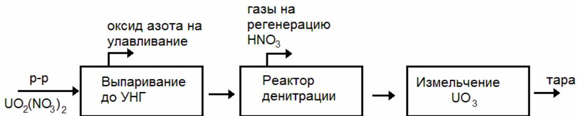
Рис. 13. Структурная схема процесса «сухой» денитрации
