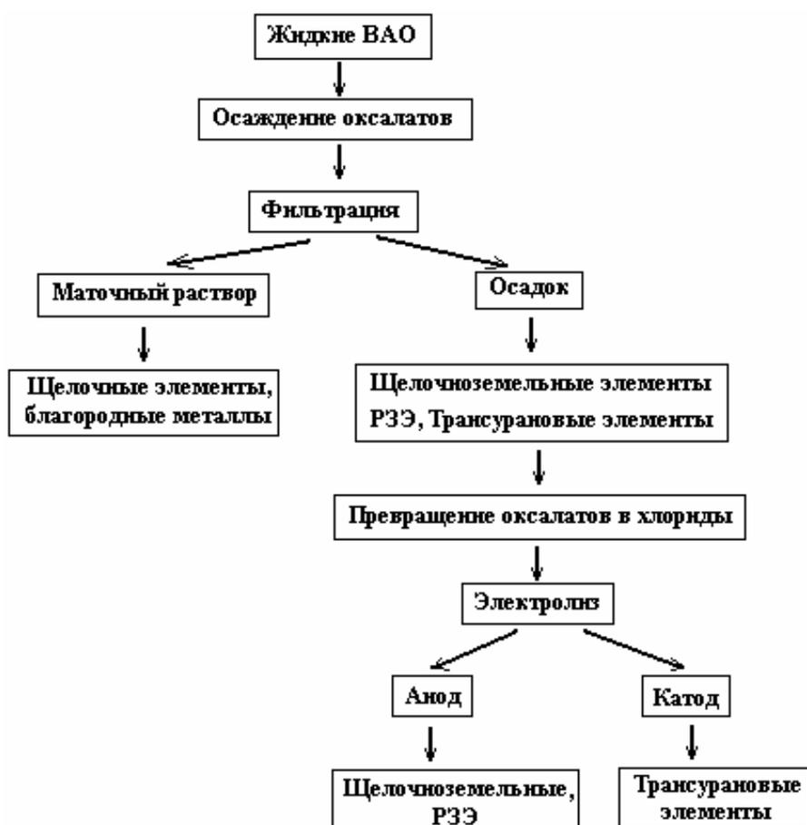
Рис. 61. Технологическая схема оксалатно-хлоридной утилизации ВАО с выделением трансурановых элементов электролизом из хлоридных расплавов
