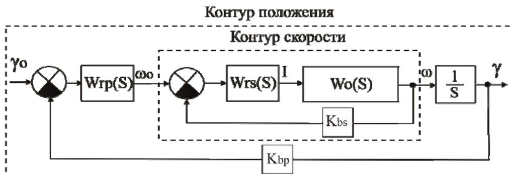
Рис. 7.3. Структурная схема системы управления шаговым двигателем
