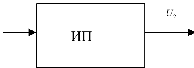
Рис. 8.1.1. Измерительный преобразователь: U_1 – входной сигнал в виде электрического напряжения; U_2 – выходной сигнал (отклик преобразователя на входное воздействие)
