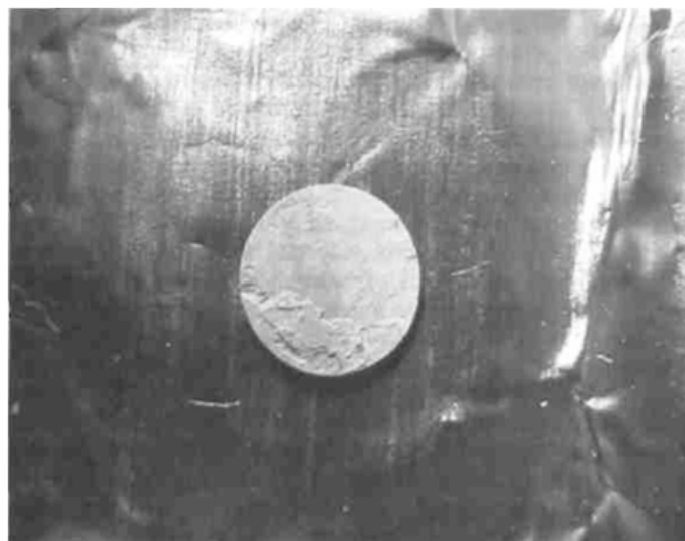
Рис. 25. Компактный образец нанокристаллического оксида ZrO_2 , приготовленный методом испарения, конденсации и компактирования, предложенным Г. Глейтером. Диаметр образца 5 мм, толщина – около 1 мм, средний размер зёрен в образце – 20 нм (Институт теоретической и прикладной физики Штутгартского университета, Штутгарт, Германия)
