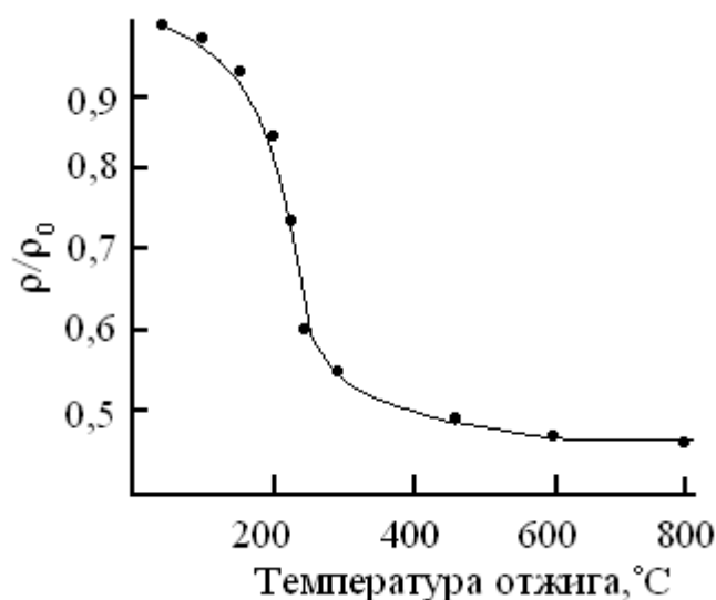
Рис. 68. Зависимость удельного сопротивления Cu от температуры отжига ( \rho_0 — удельное сопротивление ИПД Cu)
