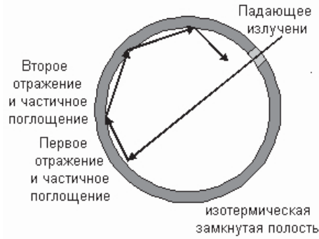
Рис. 9.6. Изотермическая замкнутая полость, моделирующая поведение черного тела
