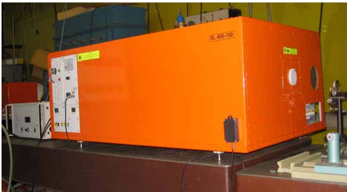
Рис. 3.9. Внешний вид эксимерного лазера EL-500-100. E = 0,5 \text{ Дж} , f = 100 \text{ Гц} , \lambda = 308 \text{ нм}
