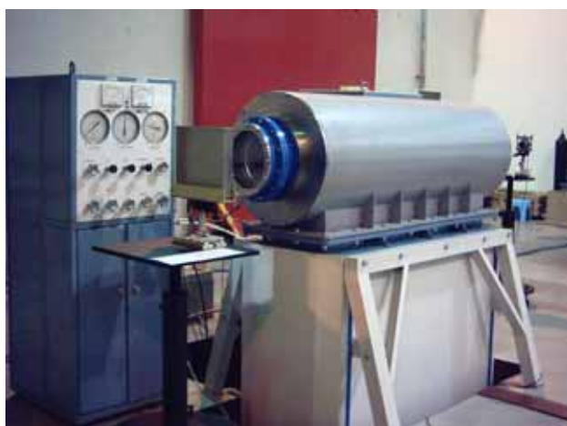
Рис. 3.10. Вид лазера с накачкой электронным пучком
