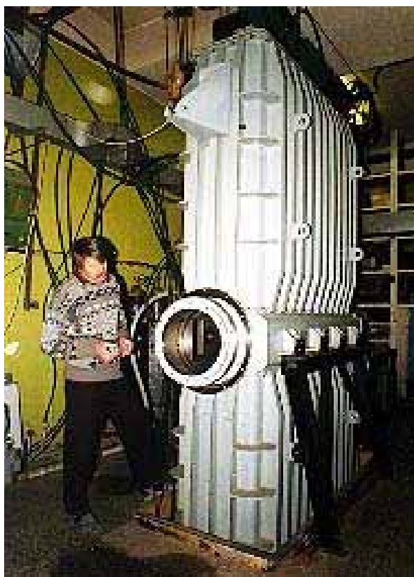
Рис. 3.11. Эксимерный лазер (200 Дж) на \lambda = 308 нм
