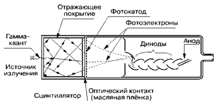
Рис. 4.1.13. Устройство фотоэлектронного умножителя
