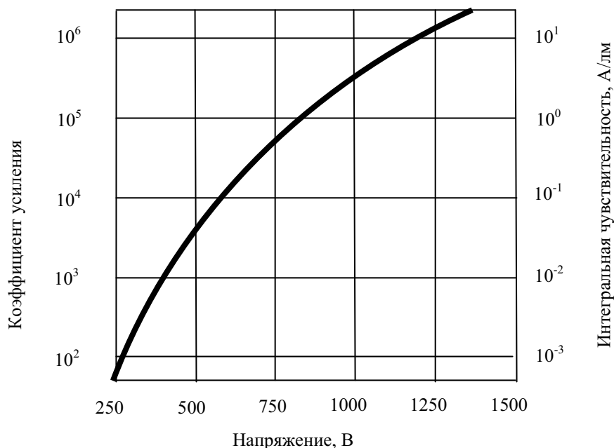
Рис. 3.2.1. Зависимость коэффициента усиления фотоэлектронного умножителя от питающего напряжения
