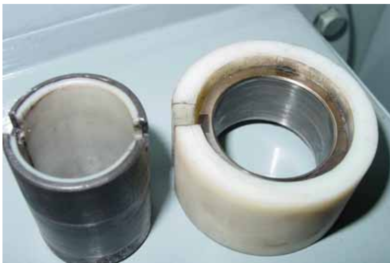
Abbildung XII.5. Teile eines Gleitlagers aus Manganhartstahl, bei denen zur Unterdrückung der Quietschgeräusche eine passend dimensionierte Polymerbeschichtung angebracht wurde
