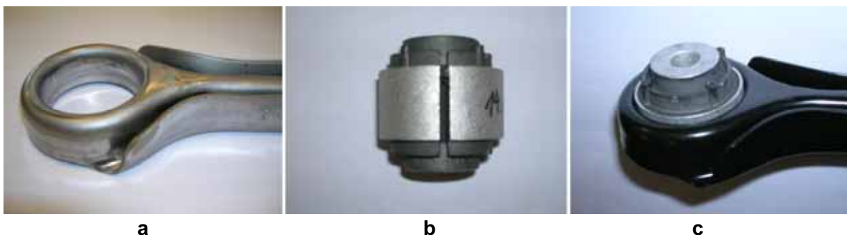
Abbildung X.16. (a) Querlenker mit Blechdurchzug, (b) Einseitig geschlitztes Gummi-Metall-Lager, (c) Fertiger Querlenker mit eingepresstem Lager
