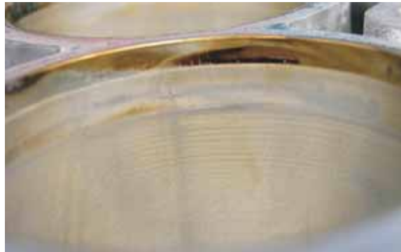
Abbildung XIII.2. Aufnahme einer Zylinderlauffläche mit ‚Waschbrett‘
