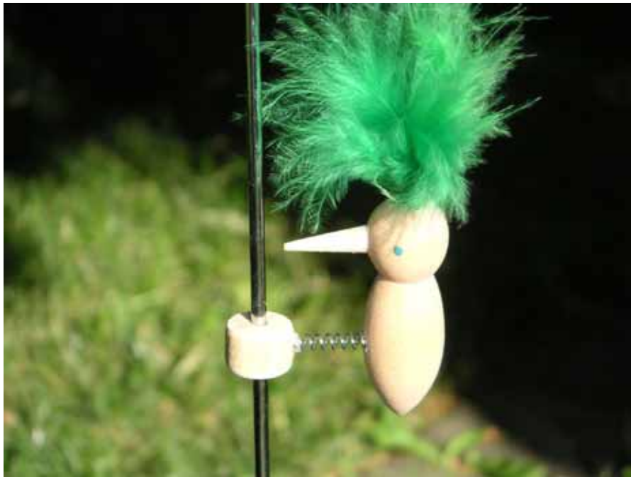
Abbildung XII.10. Im Ruhezustand ist dieses System im „selbstgesperrten“ Zustand. Lässt man den Vogel schwingen, so wird die Selbstsperrung zeitweise aufgehoben und die Halterung rutscht nach unten. Der sich einstellende Wechsel aus Haften und Gleiten ist Beispiel einer Sprag-Slip -Bewegung
