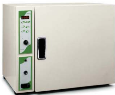
Рис. 3.56. Конвекционный сушильный шкаф ПЭ-4610, Россия
