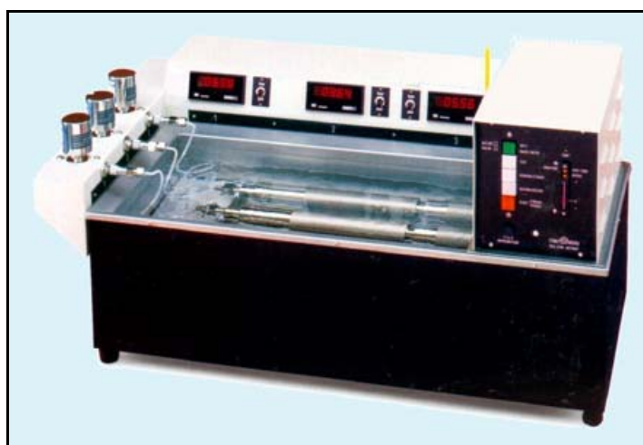
Рис. 3.60. Полуавтоматический анализатор давления насыщенных паров по Рейду Herzog-9063 (Германия)
