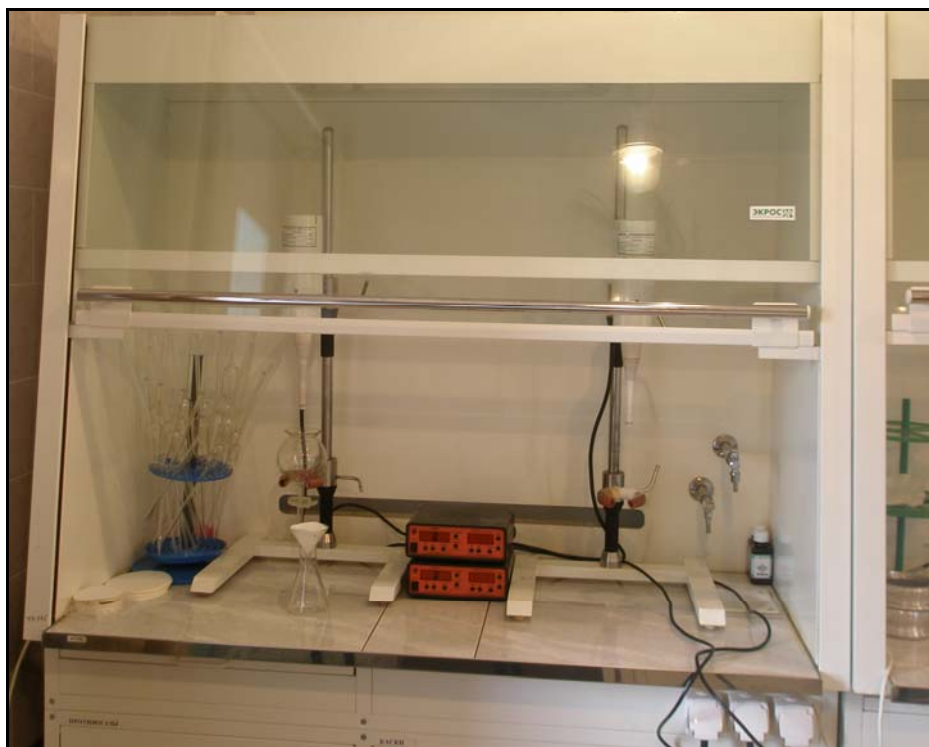
Рис. 3.53. Пример размещения в лаборатории оборудования для определения хлористых солей в нефти
