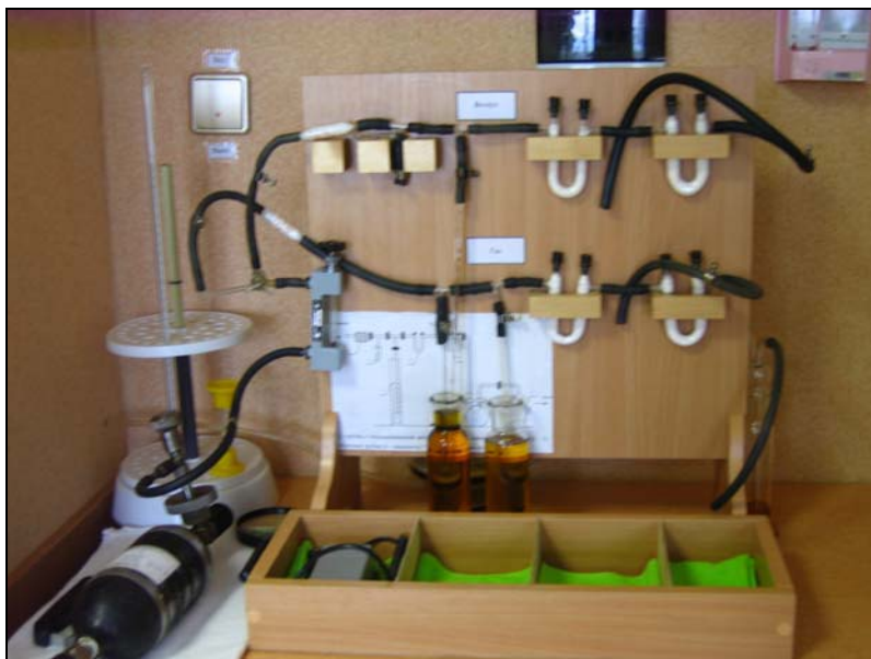
Рис. 4.23. Установка для определения пикнометрической плотности по ГОСТ 17310–2002
