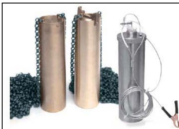
Рис. 3.2. Переносной металлический пробоотборник
