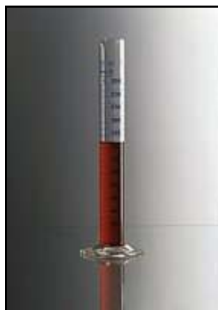
Рис. 3.69. Цилиндр для приема конденсата фракции
