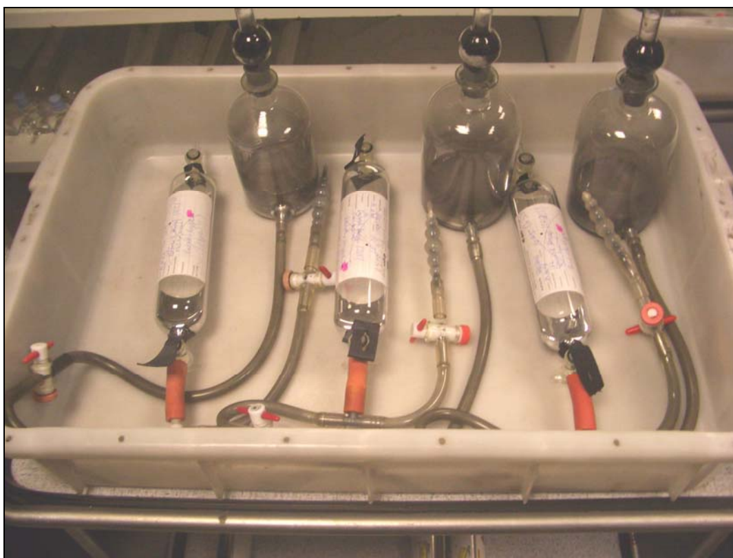
Рис. 4.16. Комплект оборудования для отбора газа без давления
