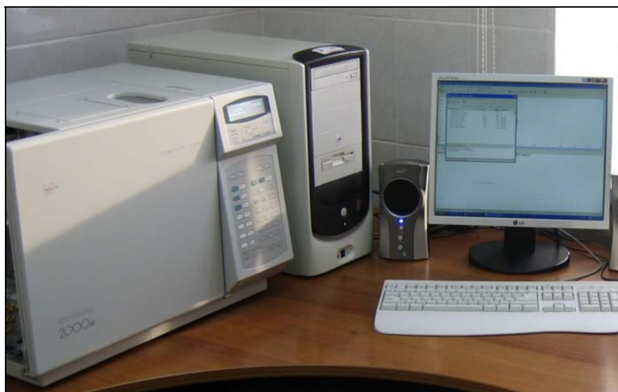
Рис. 4.24. Хроматографический лабораторный комплекс «Кристалл-2000М» для определения компонентного состава природного газа по ГОСТ 23781–87
