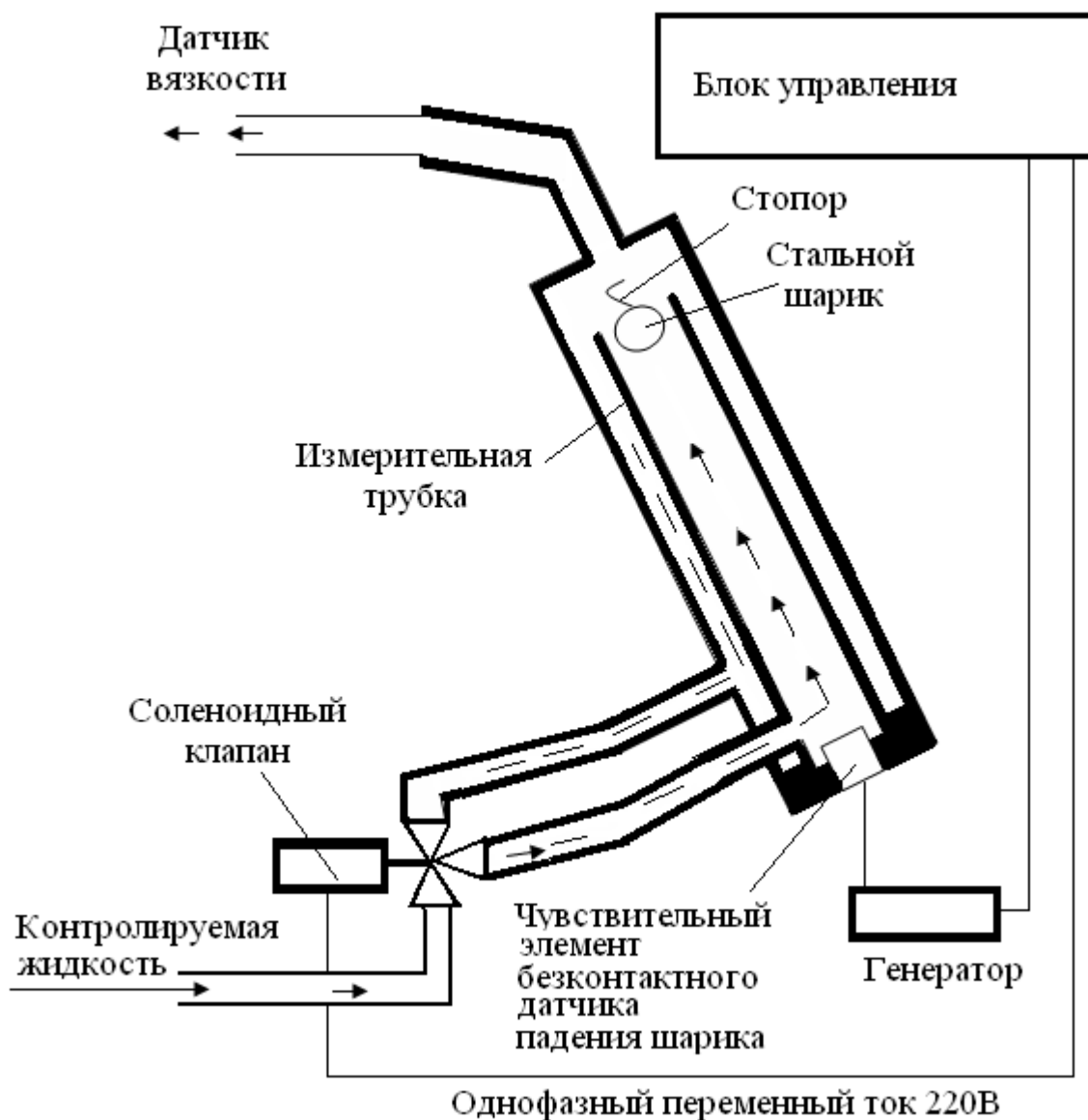
Рис. 3.25. Схема вискозиметра с падающим шариком
