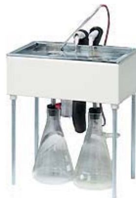
Рис. 3.75. Охладительная баня для определения парафина в нефти
