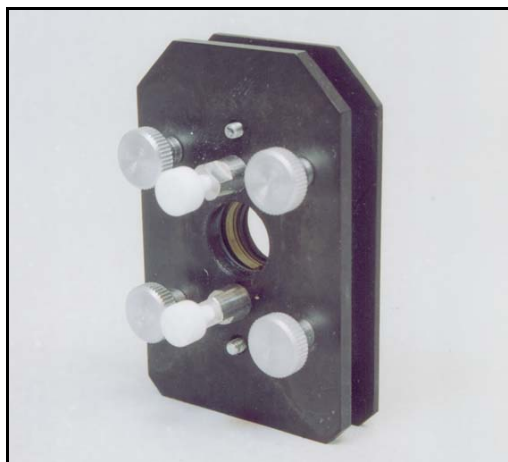
Рис. 2.10. Кювета жидкостная разборная с комплектом прокладок 0,1...1 мм: материал окон \text{KBr} и \text{CaF}_2
