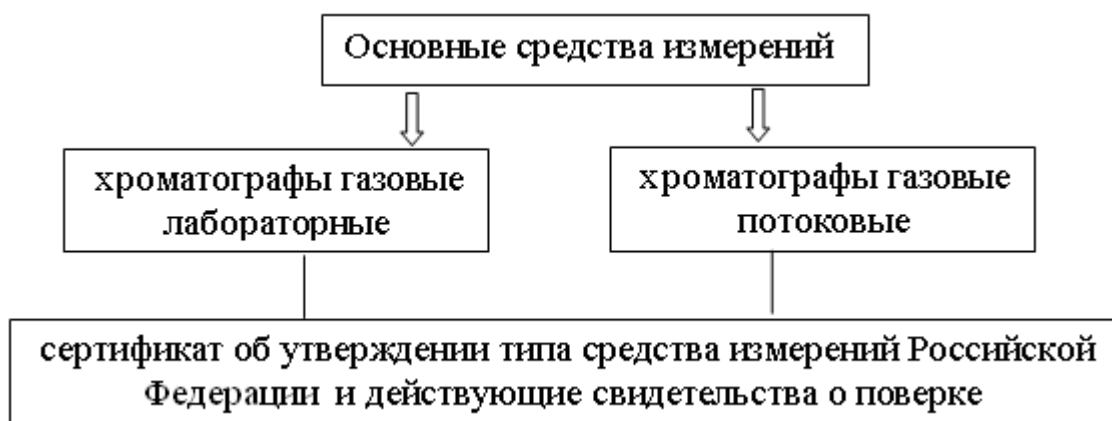
Рис. 4.27. Основные средства измерений природного газа методом хроматографии
