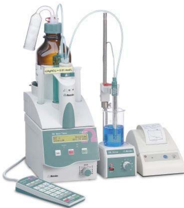
Рис. 3.62. Универсальный автоматический титратор, модель 794 Basic Titrino, Великобритания
