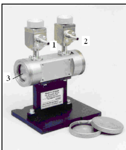
Рис. 2.8. Газовая кювета из нержавеющей стали с никелевым покрытием: 1 – входной и выходной вентили; 3 – окна диаметром 40 мм
