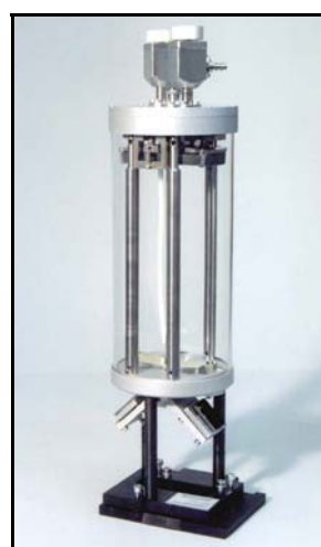
Рис. 2.9. Кювета газовая многоходовая от 0,8 до 4,8 м
