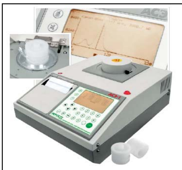
Рис. 3.43. Анализатор содержания серы в нефти и нефтепродуктах АСЭ-1
