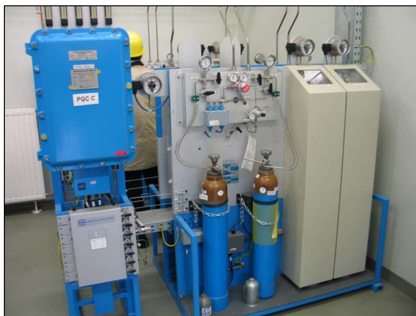
Рис. 4.25. Поточный газовый хроматограф PGC для анализа природного газа
