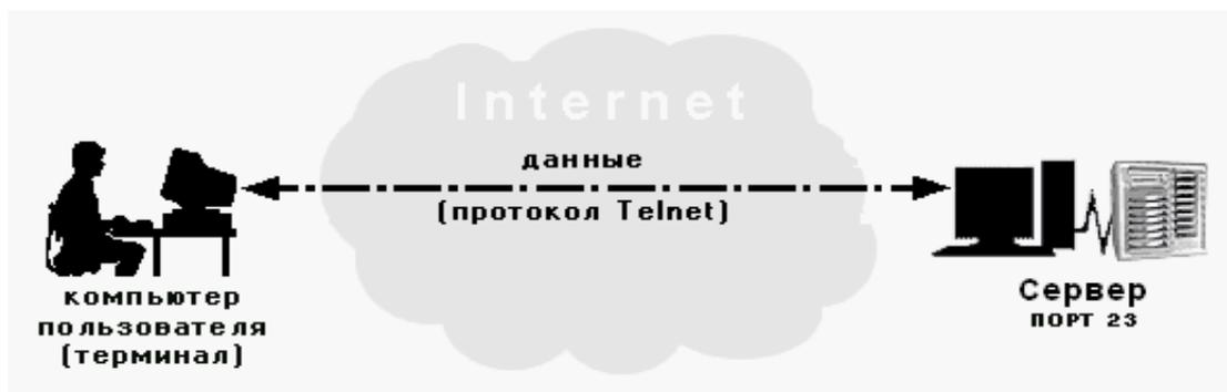
Рис. 2. Схема клиент-сервер для сервиса Telnet
