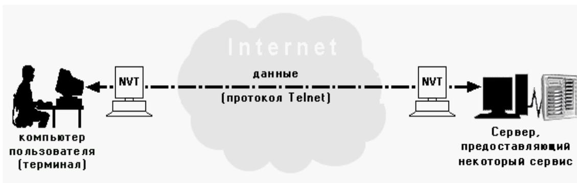
Рис. 3. Схема сетевого виртуального терминала NVT
