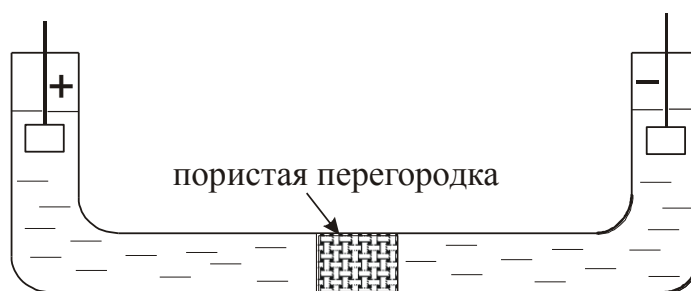
Рис. 4.38. Схема установки для изучения электромиграции ионов актиноидов
