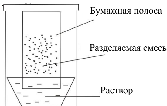
Рис. 4.14. Установка для хроматографии на бумаге
