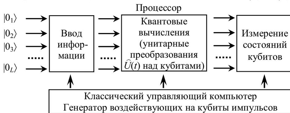
Рис. 3.32. Схематическая структура квантового компьютера
