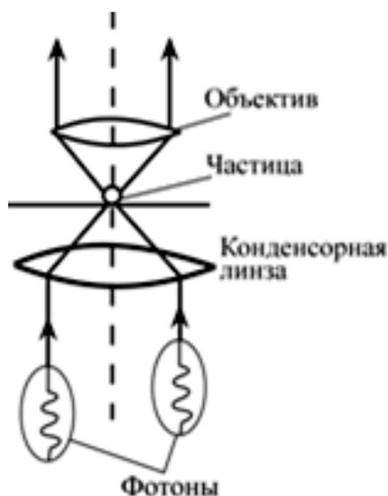
Рис. 3.4. Взаимодействие в микроскопе фотонов с частицей приводит к неопределённости её импульса в момент наблюдения  $\Delta p \geq h/\lambda$
