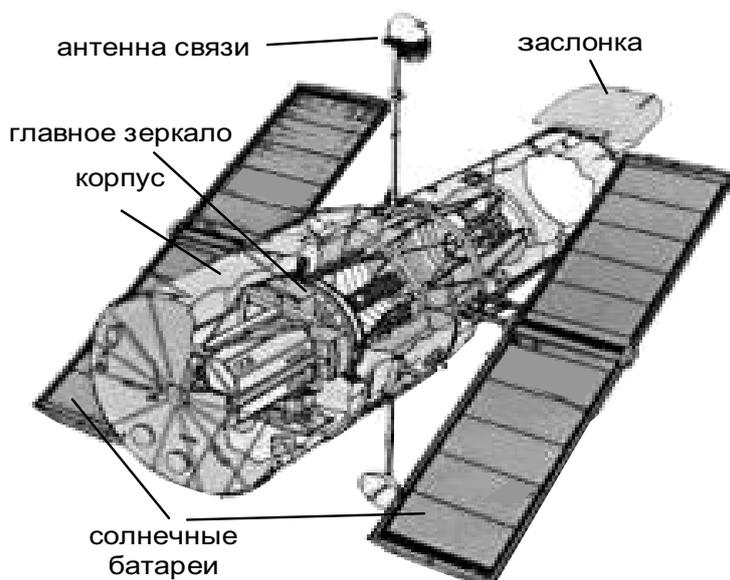
*Рис. 3.31. Орбитальный космический телескоп-рефлектор Хаббл, имеющий отражающее зеркало диаметром 2,4 м и позволяющий получить оптическое разрешение порядка 0,1 угловой секунды. Длина космического аппарата – 13,3 м, диаметр – 4,3 м, масса с установленными приборами около 12,5 т*
