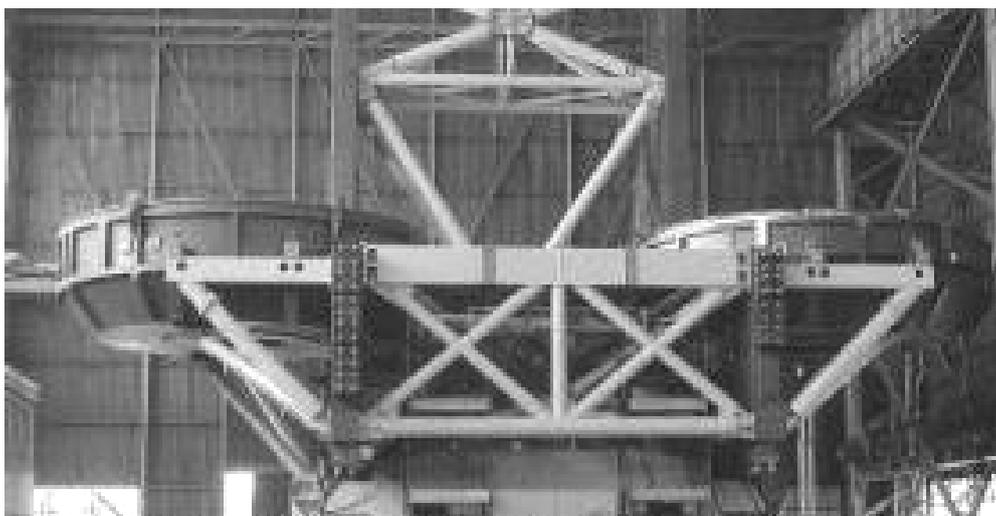
*Рис. 3.29. Первичные зеркала большого бинокулярного телескопа диаметром 8,4 м расположены на расстоянии 14,4 м друг от друга (телескоп ЛВТ)*
