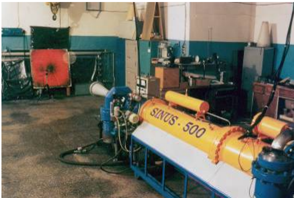
Рис. 1.2. Излучение импульсно-периодического СВЧ-генератора заставляет светиться табло из неоновых ламп
