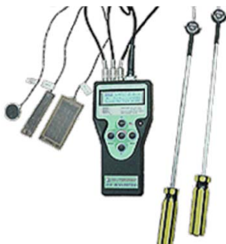
Рис. 6. Измеритель теплового потока ИТП-МГ4.03
