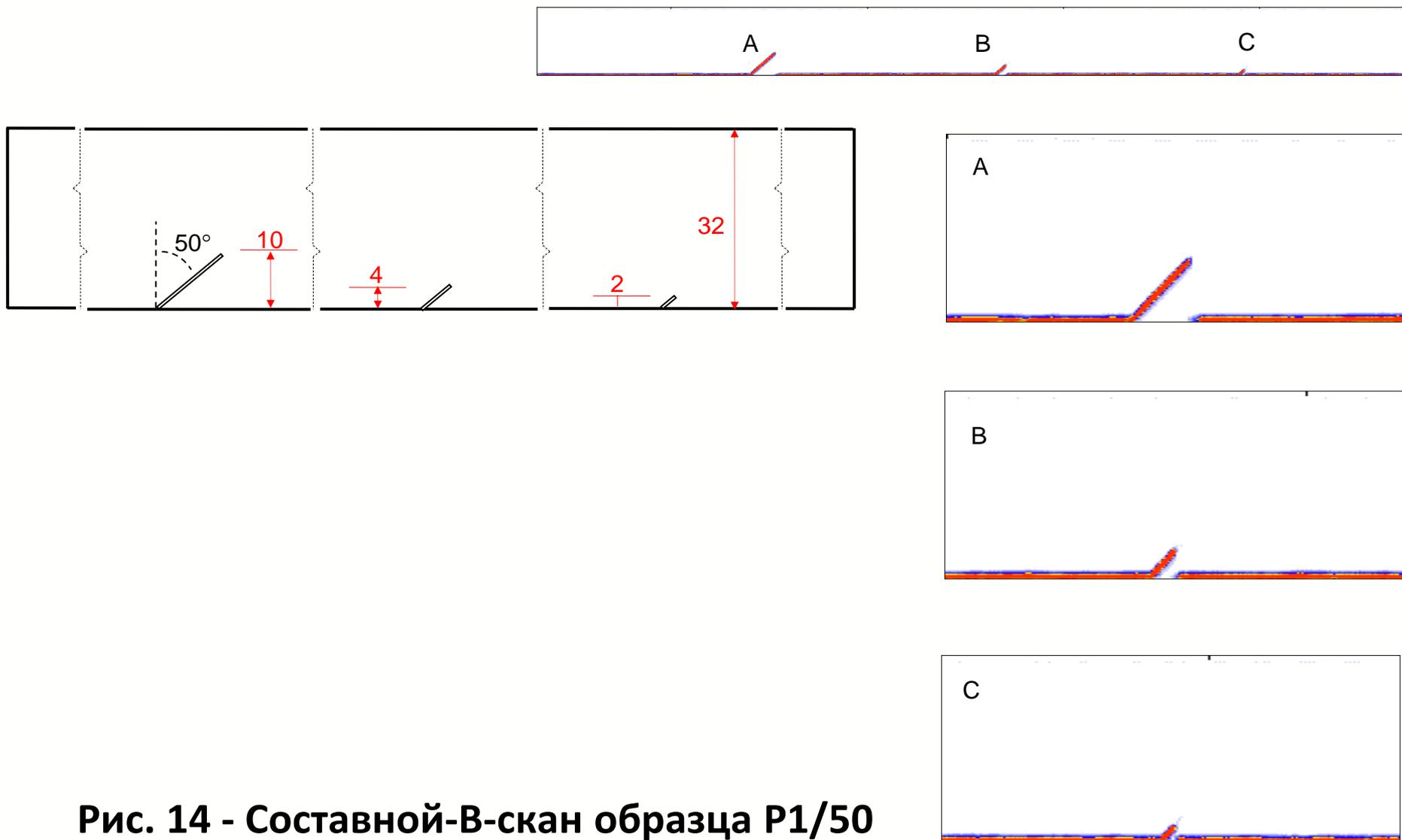
Рис. 14 - Составной-B-скан образца P1/50
