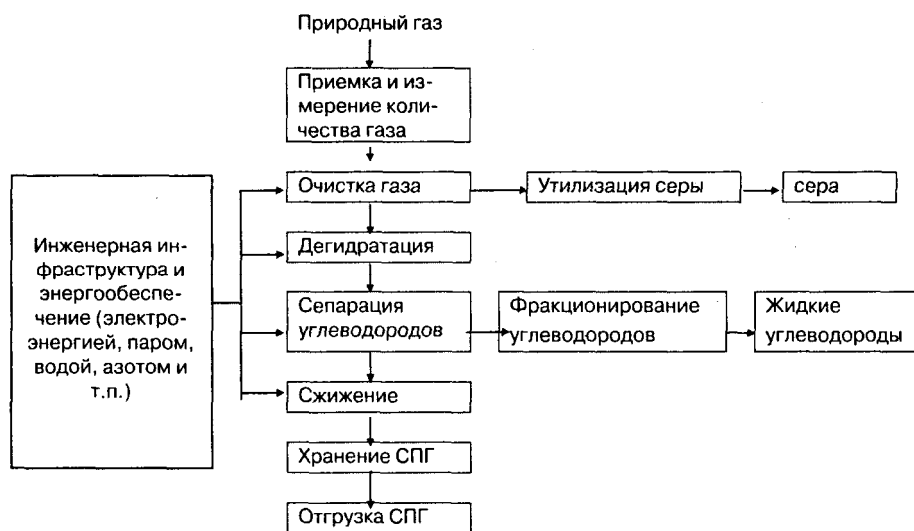
Рис. 15. Технологическая схема завода по сжижению природного газа
