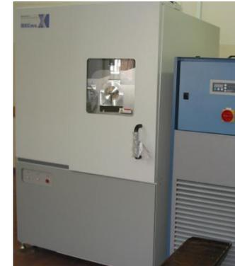
**Дифрактометр XRD-7000S (Shimadzu) с высокотемпературной приставкой 20...2200°C**
