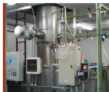
Водоочистной комплекс «Аэрозон-5» производительностью до 5 м 3 /ч
