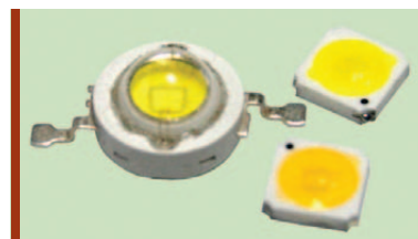
Светодиоды на основе твердых растворимых нитрида и фосфида элементов третьей группы (индия, галлия и алюминия) поверхностного монтажа предназначены для светотехнических устройств
