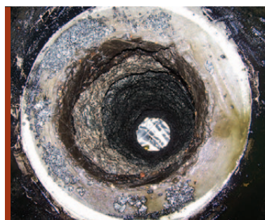
Скважина диаметром 380–400 мм и глубиной 2 м, пробуренная в образце гранита. Скорость бурения — 2 м/час
