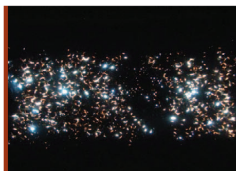
Фотография разряда в слое железных гранул
