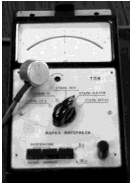
Рис. 2.1. Внешний вид прибора с магнитоупругим датчиком для измерения величины остаточных напряжений
