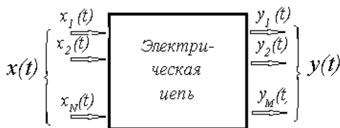
Рис. 1.5. Представление электрической цепи
