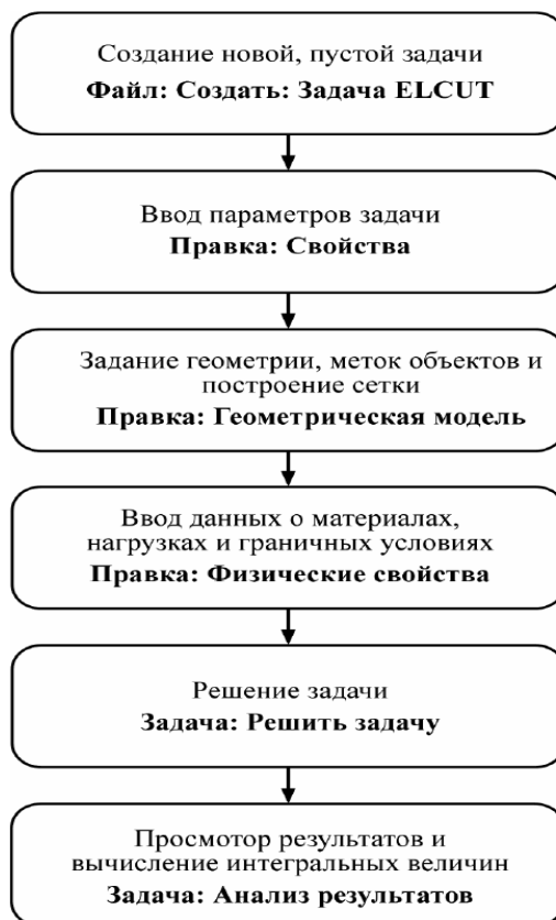
Рис. 6.3. Алгоритм разработки пользовательской программы
