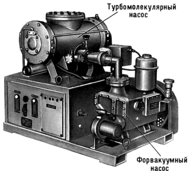
*Рис. 3.20, б. Установка турбомолекулярного насоса с форвакуумным механическим насосом*
