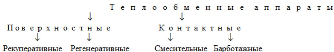
Рис. 1 – Классификация теплообменных аппаратов
