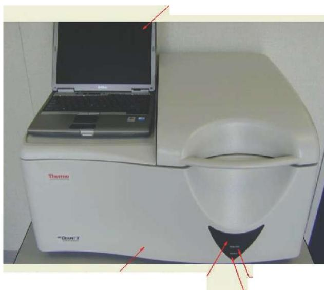
*Рис. 36. Фоторафия EDXRF спектрометра*
