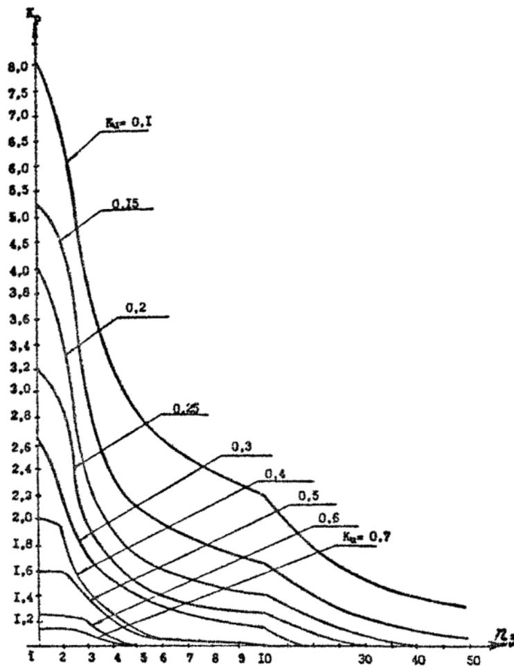
Кривые коэффициента расчетных нагрузок  $K_p$  для различных коэффициентов использования  $K_{и}$  в зависимости от  $n_{Э}$  (для постоянной времени нагрева  $T_0=10$  мин)
