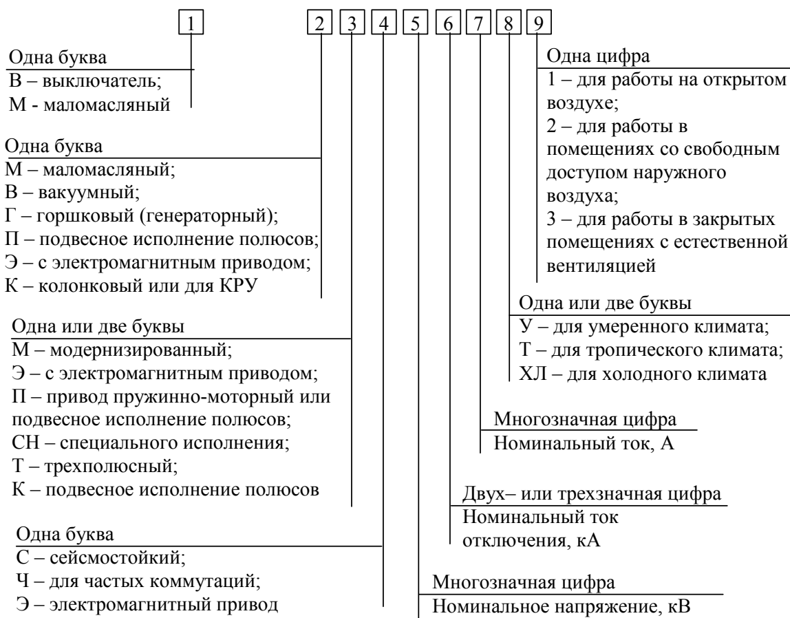
Рис. 7.2. Структура условного обозначения выключателей высокого напряжения
