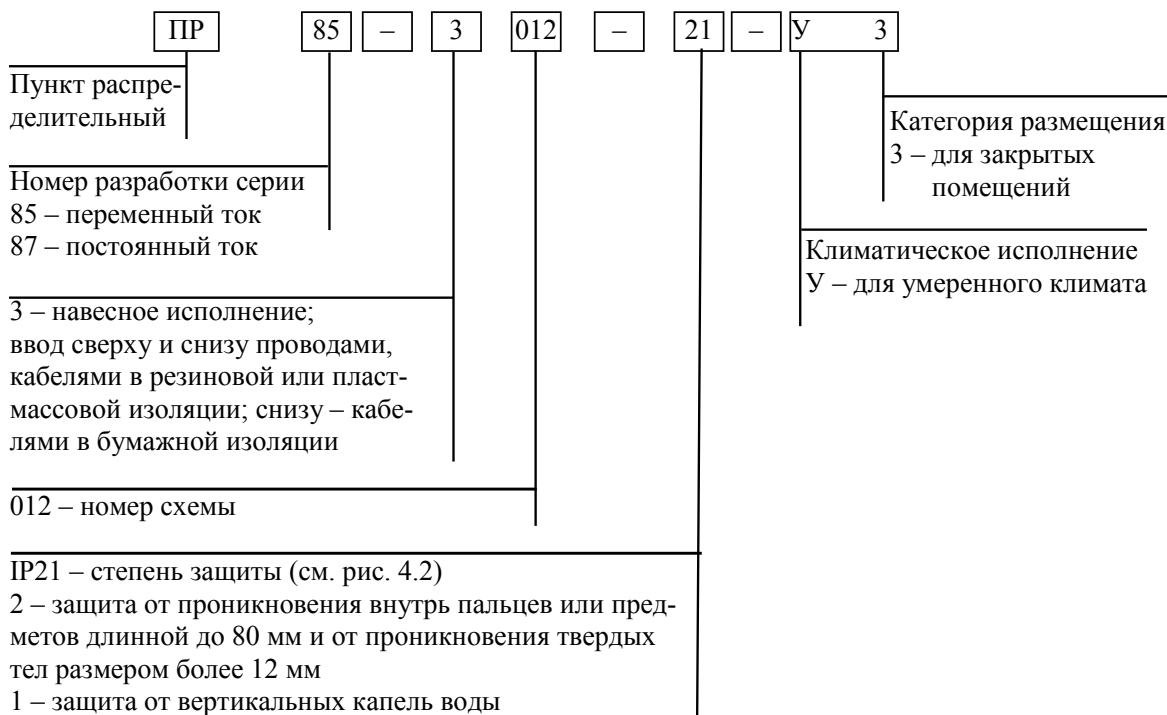
Рис. 4.3. Структура условного обозначения распределительного пункта серии ПР85 и ПР87
