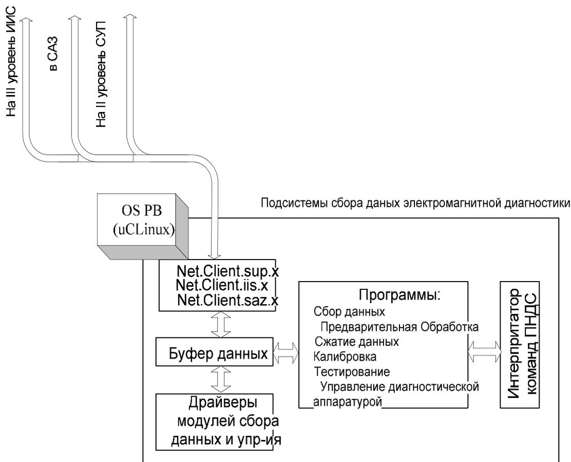
Рисунок 7.1.1. Структура программного обеспечения уровня II ИИС.
