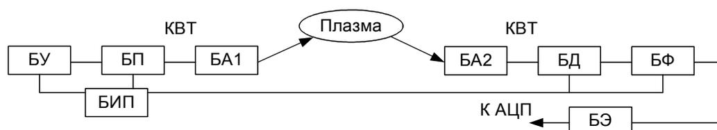
Рисунок.8.2.1.1 Структурная схема ОИ; БУ – блок управления и контроля, БП – блок передатчиков, БА1 – блок передающих антенн, БА2 – блок приемных антенн; БД – блок детекторов с предусилителями, КВТ – квазиоптический и волноводный тракты, БФ – блок формирователей, БЭ – блок электроники, БИП – блок источников питания, АЦП – аналого-цифровой преобразователь. Размеры всех блоков, кроме блока антенн и КВТ, не превышают  $20*20*15\text{ см}^3$  для каждого.
