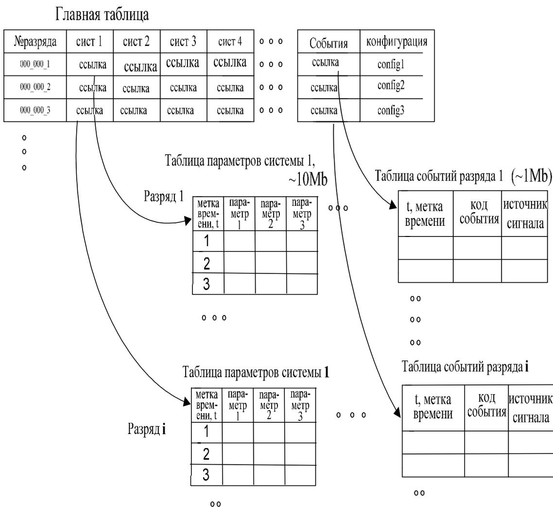
Рисунок 3.2.5.2. Реализация БДРИ на основе реляционной модели данных.
