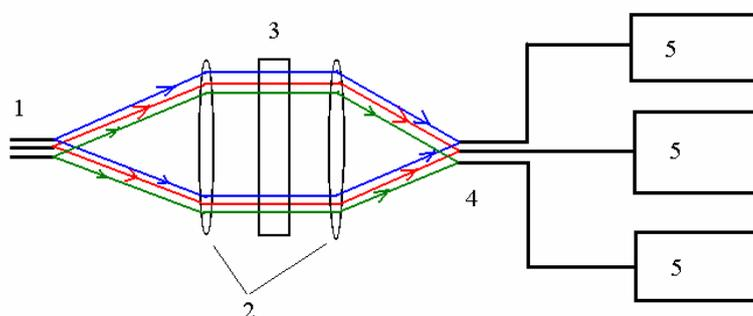
Рисунок 8.2.3.2 Структурная схема монитора На-Да; 1 – световоды, приходящие с установки и собирающие свет по разным хордам наблюдения, 2 – объектив, создает для каждого световода параллельные пучки света, которые проходят через интерференционный фильтр, 3 – Второй объектив, 2 – собирает свет на систему световодов, 4 – световоды, 5 – ФЭУ и предусилители
