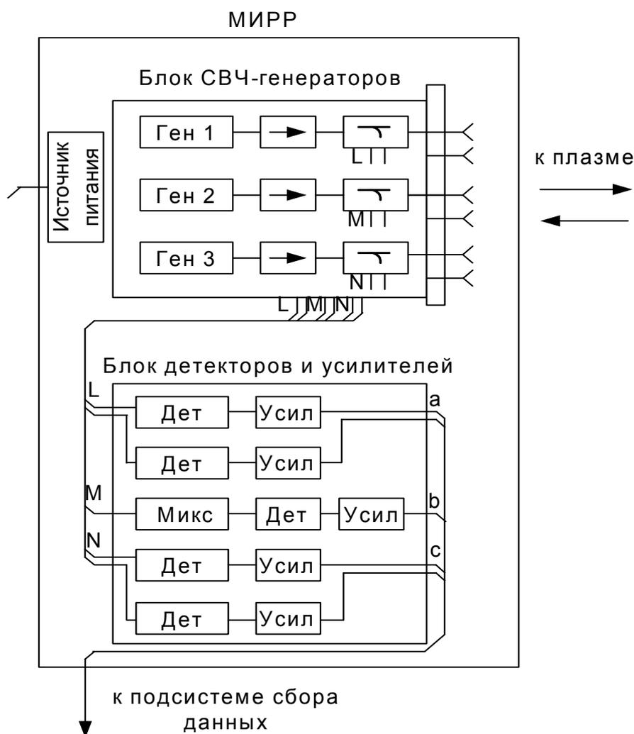
Рисунок.8.2.2.1 Структурная схема радар-рефлектометра.
