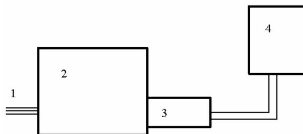
Рисунок 8.2.4.1. Структурная схема диагностики Na-Da, 1 – Набор световодов, приходящих с установки; 2 – Светосильный спектральный прибор высокого разрешения; 3 – Блок считывающей электроники, в составе: Усилитель яркости, ПЗС-матрица, считывающая электроника; 4 – подсистема сбора данных
