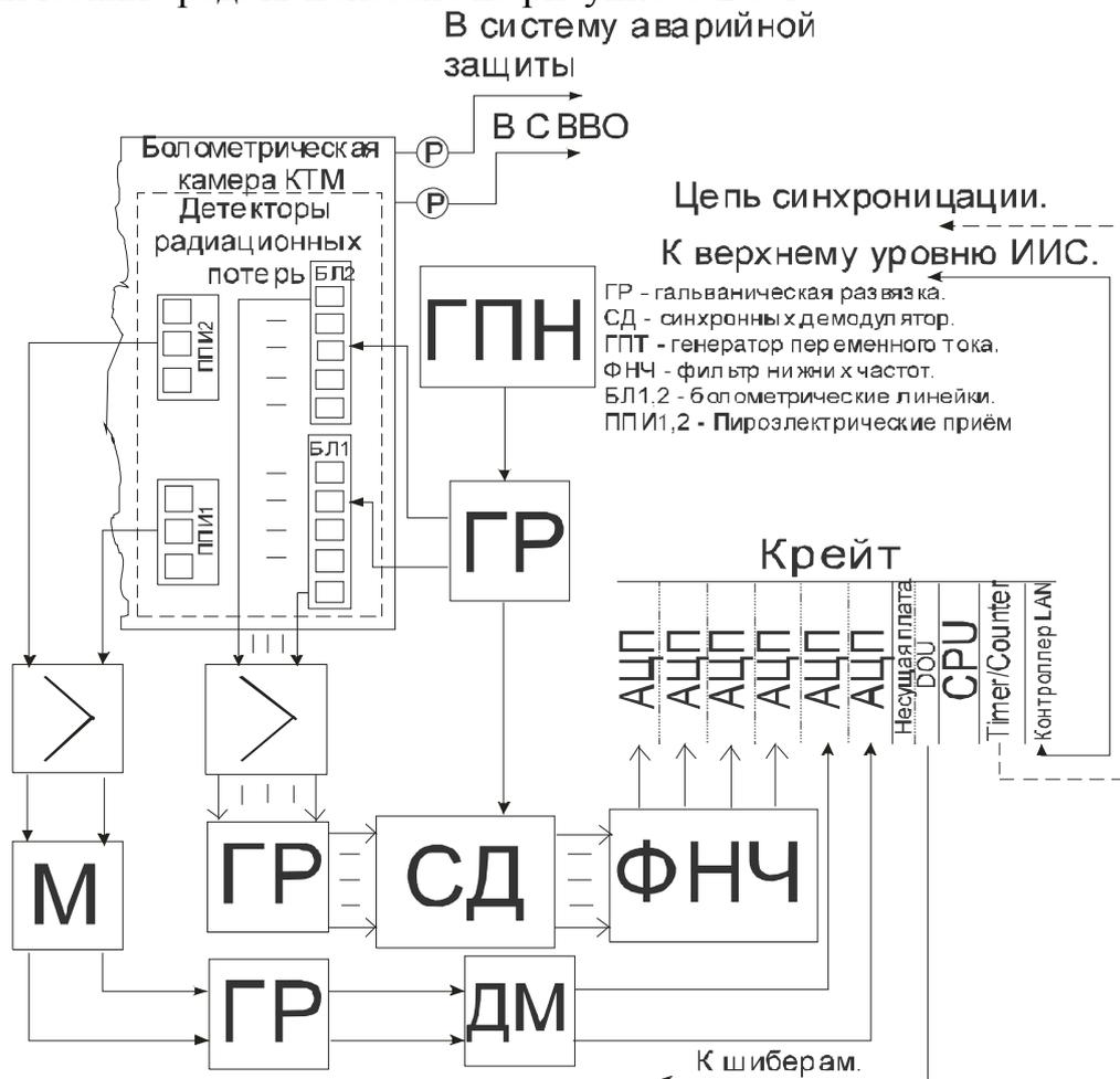
Рисунок.8.2.9.1 Структурная схема ПСД многоканальной болометрии.
