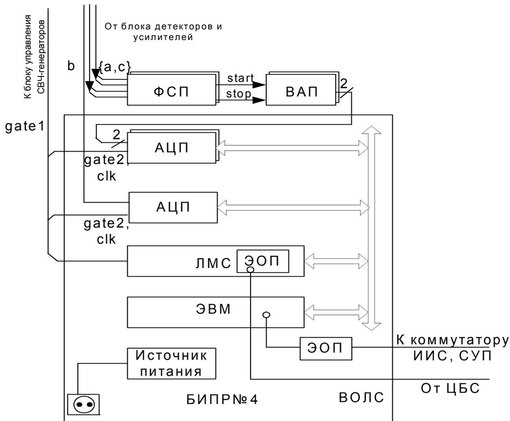
Рисунок.8.2.2.2 Структурная схема подсистемы сбора данных.
