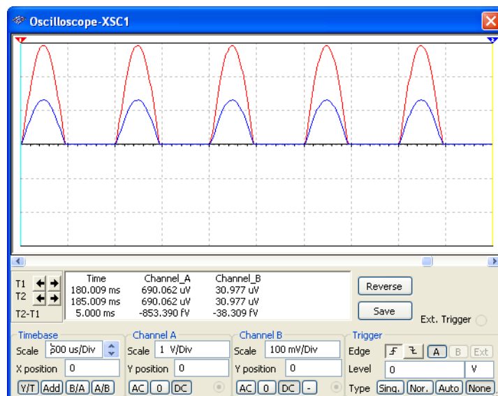
Рис. 4.45. временные диаграммы выходного напряжения и тока диода выпрямителя
