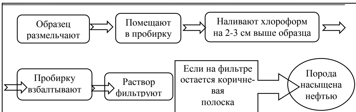
3 способ. Выявление признаков нефти с применением хлороформа .
