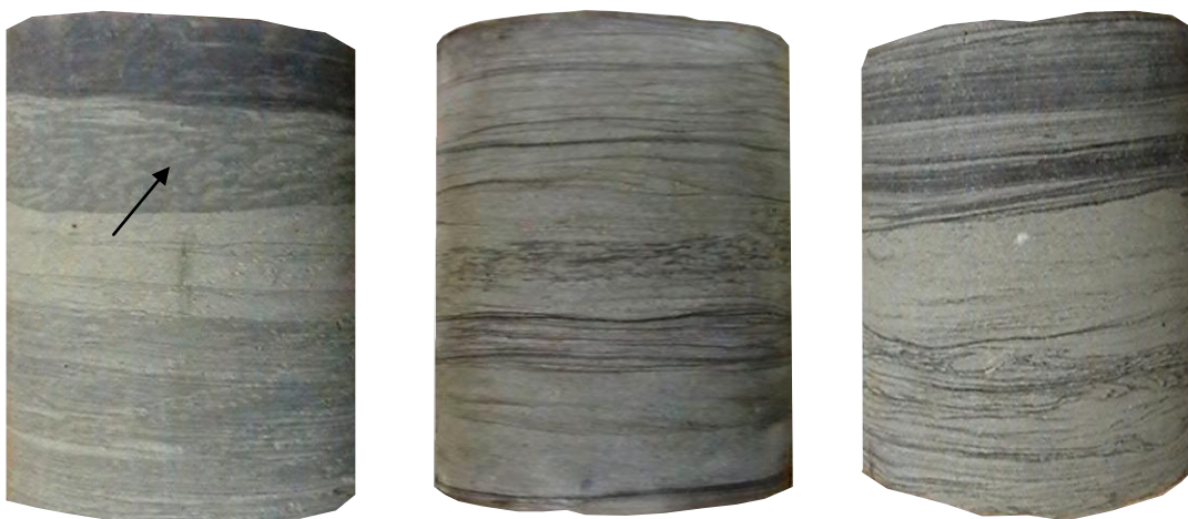
различные типы пологоволнистой слоистости, тонкие прослойки угля, тонкая рябь (показано стрелкой) в породах верхней части старичных отложений
