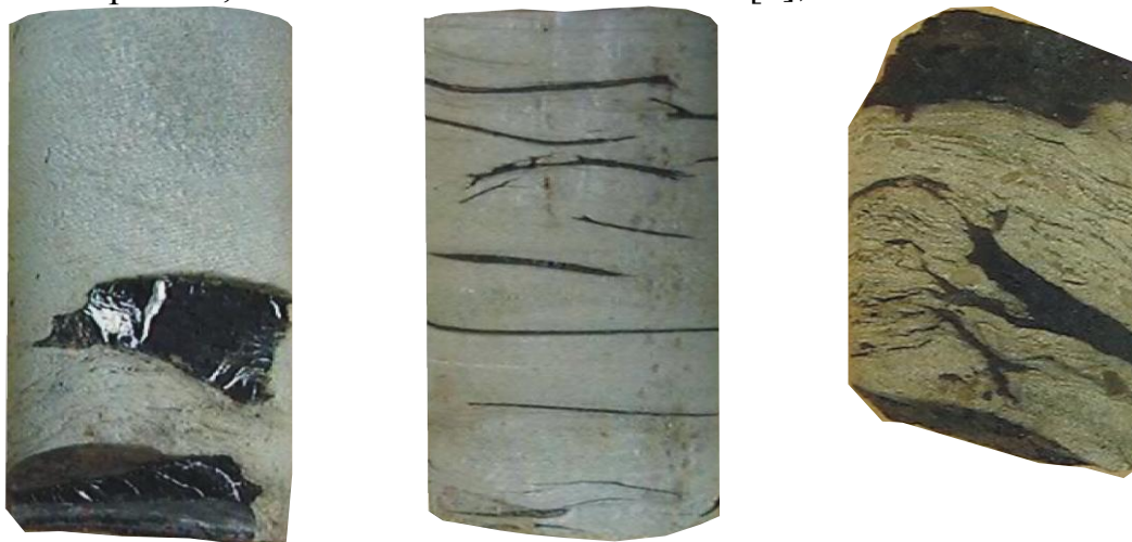
обломки, прослойки и включения угля в песчаниках
