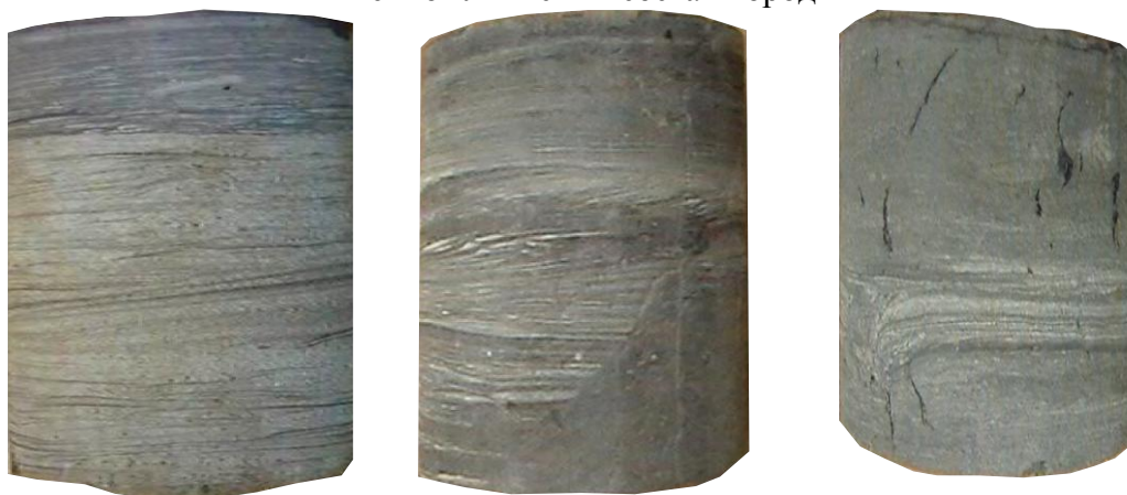
переслаивание алевритового и глинистого материала, растительный детрит, сочетание пологонаклонной и горизонтальной слоистости, размыв осадков
