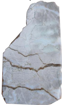
каверна в известняке, заполненная битумом
