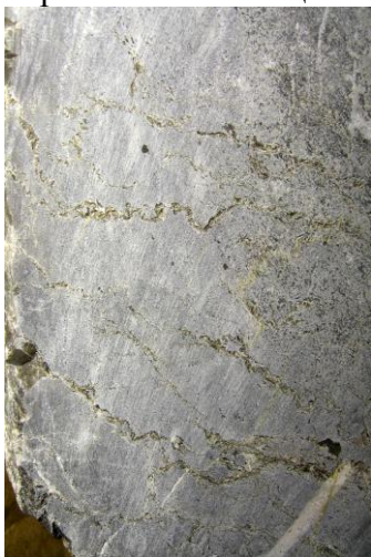
известняк хемогенный со стилолитовыми швами
