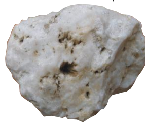
коллектор трещинного типа – известняк с открытыми трещинами и прожилками кальцита
