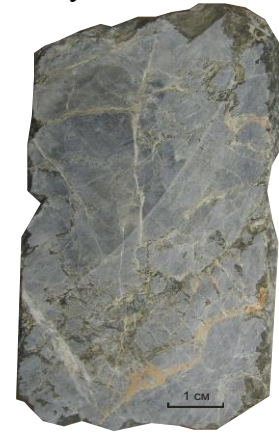
коллектор трещинного типа – известняк хемогенный со стилолитовым швом, заполненным битумом
