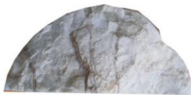
коллектор кавернового типа – известняк
