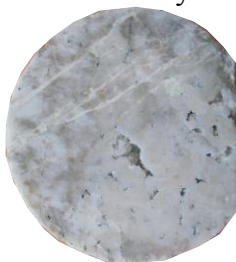
Образцы Т.А. Гайдуковой хемогенный (А) и комковатый (Б) известняки – коллекторы трещинного типа с битум
