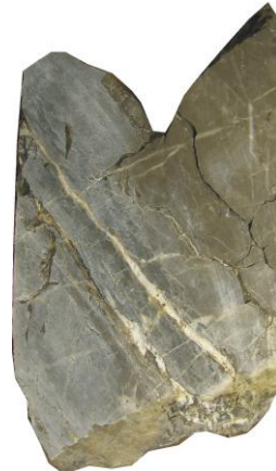
коллектор трещинного типа – известняк хемогенный со стилолитовым швом, заполненным битумом
