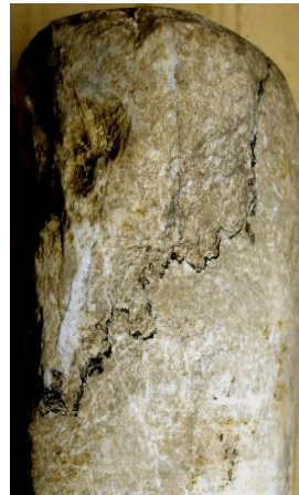
коллектор трещинного типа – известняк хемогенный со стилолитовым швом, заполненным битумом
