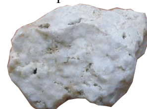
коллектор каверново-трещинного типа – растворение известняка вблизи и в прожилках
