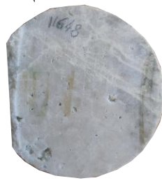
Т.А. Гайдуковой нефтяное вещество и кальцит в трещинах в доломите – коллекторе трещинного типа
