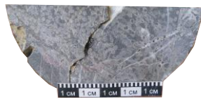
Образцы Т.А. Гайдуковой хемогенный (А) и комковатый (Б) известняки – коллекторы трещинного типа с битум
