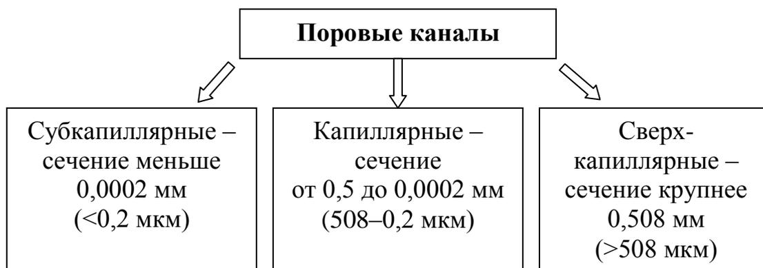
Рис. 2.12. Характеристика пустотного пространства по их размерам
