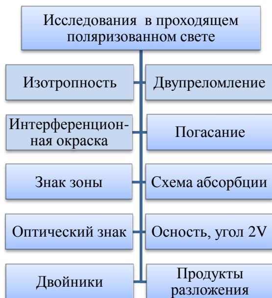
Рис. 18. Схема изучения минералов при двух николях
