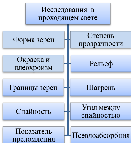
Рис. 8. Схема изучения минералов при одном никеле
