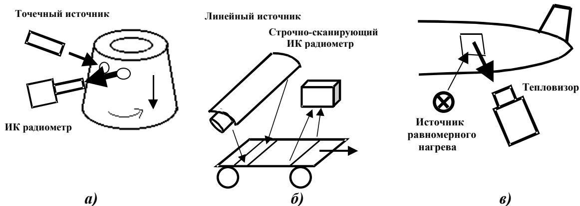
Рис. 1.7. Процедуры ТК в зависимости от вида зоны контроля и нагрева: а – поточечное сканирование, б – строчное сканирование, в – тепловизионный способ
