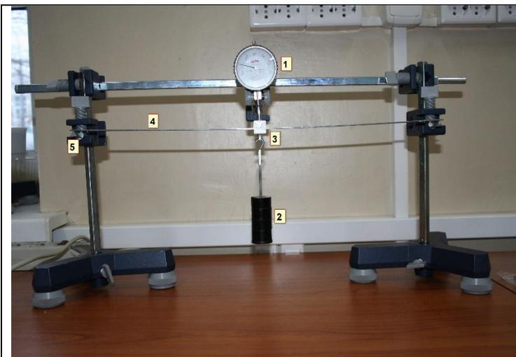
Рис. 4а Установка для измерения стрелы
