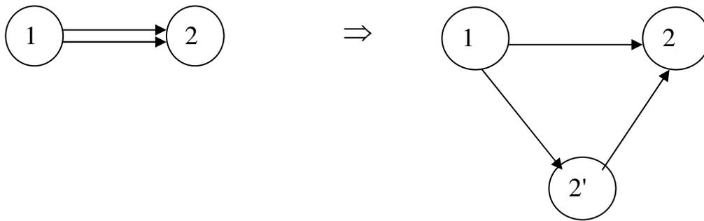
Рис. 38. Пример введения фиктивного события для устранения параллельности работ
