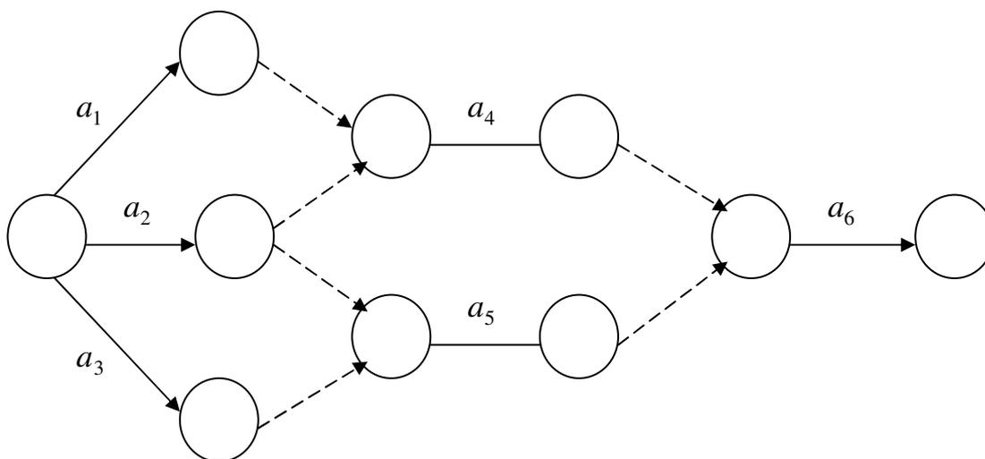
Рис. 36. Сетевой график комплекса работ
