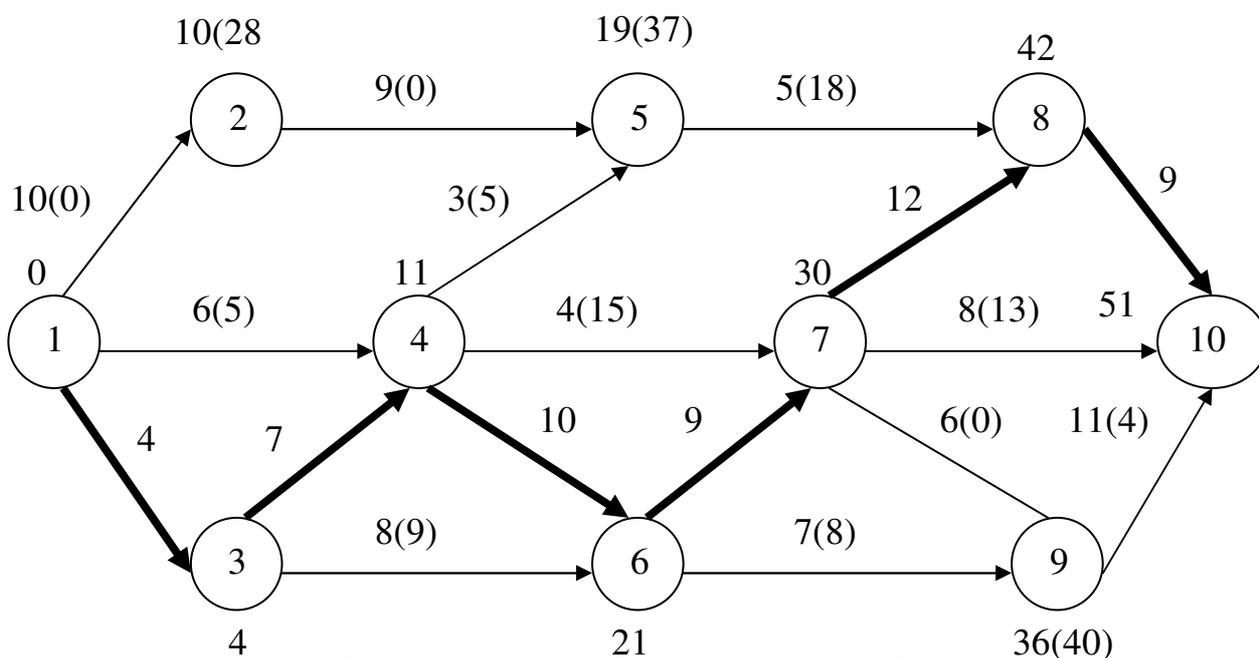
Рис. 42. Упорядоченный сетевой график
