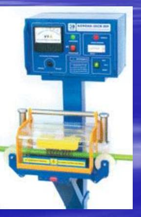
Основан регистрации на параметров электрического поля, взаимодействующего объектом. контролируемым Первичными информативными параметрами являются: электрическая емкость ИЛИ потенциал.
