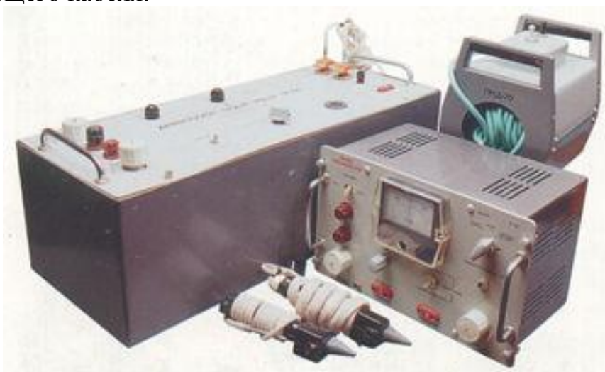
Рис. 6 Магнитопорошковый дефектоскоп ПМД-70
