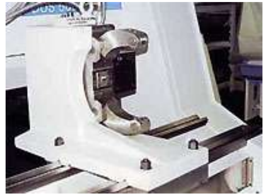
Неподвижный самоцентрирующийся люнет с приводом от гидравлики
