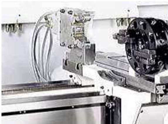
Подвижный самоцентрирующийся люнет с приводом от гидравлики
