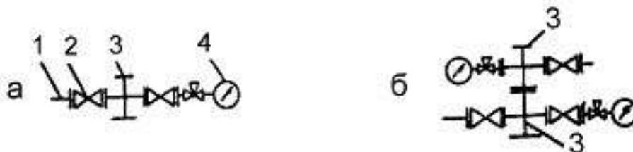
Рис. 7.3. Схемы трубных обвязок фонтанной арматуры: 1 – ответный фланец; 2 – запорное устройство; 3 – трубная головка; 4 – манометр с запорно-разрядным устройством
