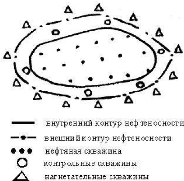
Рис. 6.2. Схема законтурного заводнения
