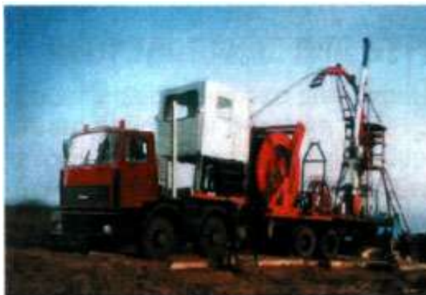
Рис. 4.3. Колтюбинговая установка М20 в рабочем положении
