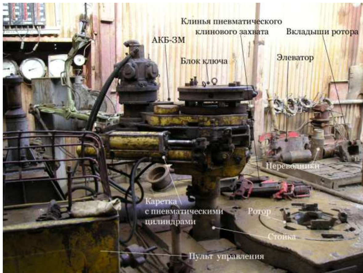
Рис. 4.15. Ключ буровой АКБ-3М
