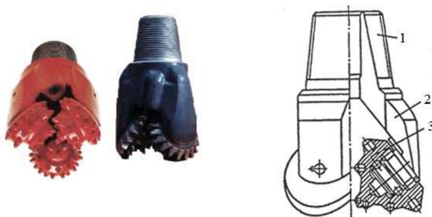
Рис. 4.19. Шарошечное долото: 1 – корпус с резьбовой головкой; 2 – лапа с опорой; 3 – шарошка
