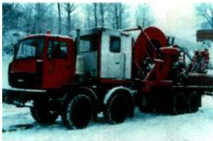
Рис. 4.4. Колтюбинговая установка М20 в транспортном положении
