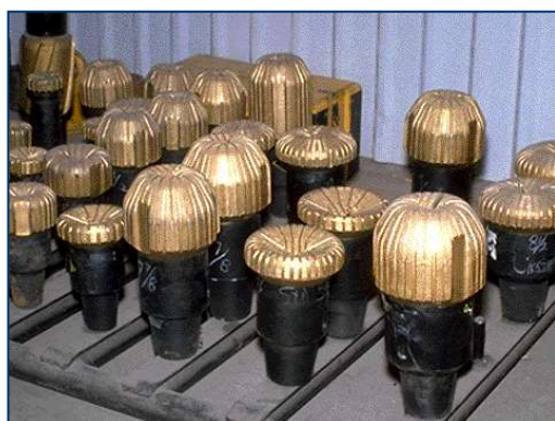
Рис. 4.20. Алмазное долото: 1 – корпус; 2 – матрица; 3 – алмазные зерна
