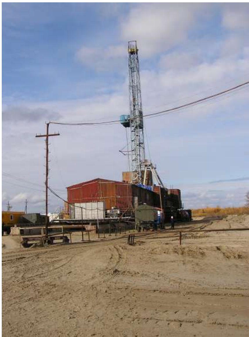
Рис. 4.10. Буровая установка с одноопорной вышкой мачтового типа
