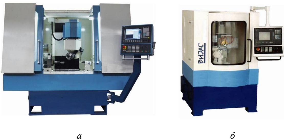
Рис. П. 2.1. Общий вид шлифовально-заточных станков с ЧПУ
