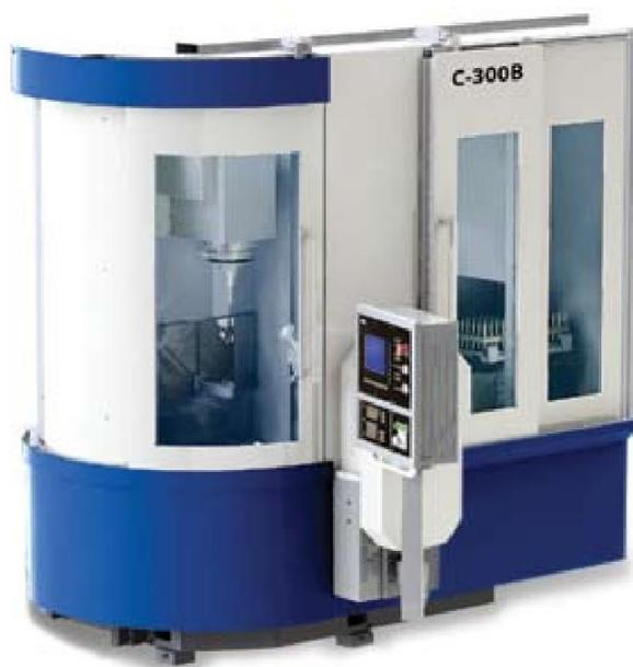
Рис. П. 2.5. Шестикоординатный шлифовально-заточной станок модели С-300В ОАО НИПТИ «Микрон» (Россия)
