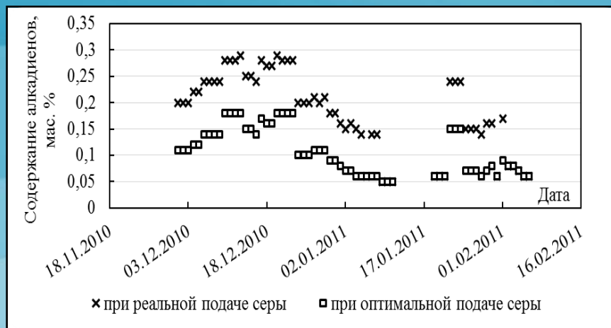
Содержание алкадиенов в продуктах процесса гидрирования при различных режимах осернения катализатора (модельные исследования)
